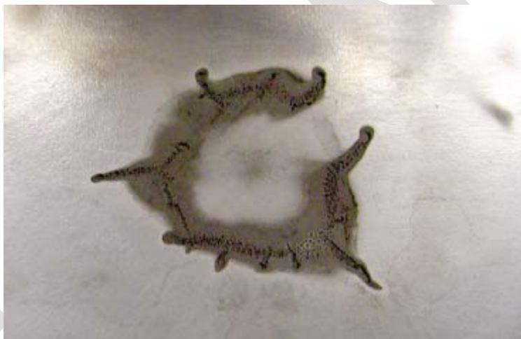
（不正确操作方式造成的清洗槽损伤）
